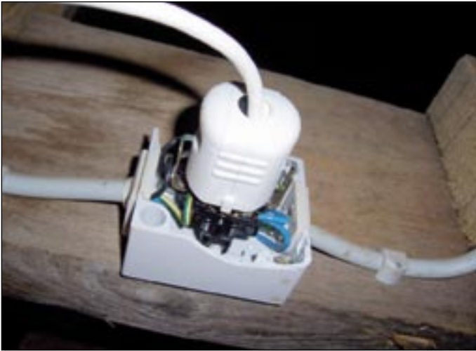
Mynd 10. Brotinn tengill, snertihætta.
